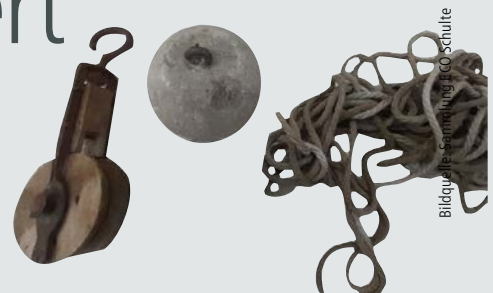
Bestandteile eines Seilzuges zu Türschließen, Deutschland, 17. Jahrhundert.
